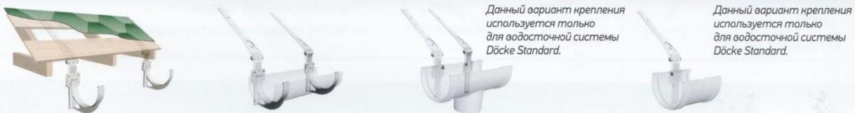
Данный вариант крепления используется только для водосточной системы Döcke Standard.
