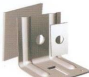
Крепежные кронштейны КК-50 (90, 120, 150, 180 и 230), с шайбой и изоляционной прокладкой, t=1.2 и 2.0 мм
